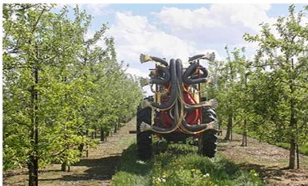
Şək. 5.7.2. ABŞ-ın Aqrar Tədqiqatlar Xidmətinin hazırladığı lazer yönləndirici ilə işləyən dəyişən tezlikli çiləmə aqreqatının işçi vəziyyətdə sistemi
