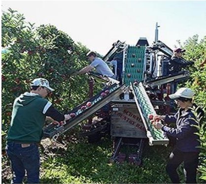
Şək. 5.7.4. Transportyorlu, platformalı avtomatik çeşidləyən, ayıran və qiymətləndirən aqreqatın iş vaxtı görünüşü.
