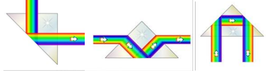
Şəkil 2. Tam daxili qaytarıcı prizma və istiqamətlərinin dəyişdirilməsi
