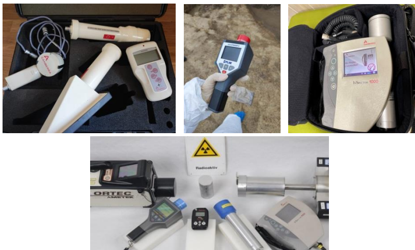
Fondlarda radioaktivliyi ölçmək üçün istifadə olunan daşınabilən dozimetrlər
